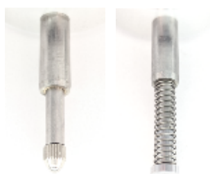
Рисунок 4 – Общий вид сменных наконечников отсчетных устройств
